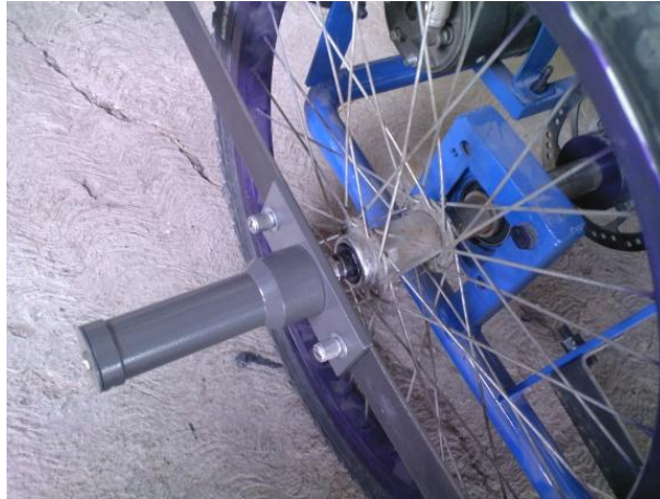
Figura 4.13. Adaptación de tacómetro al eje de tracción del vehículo eléctrico.
