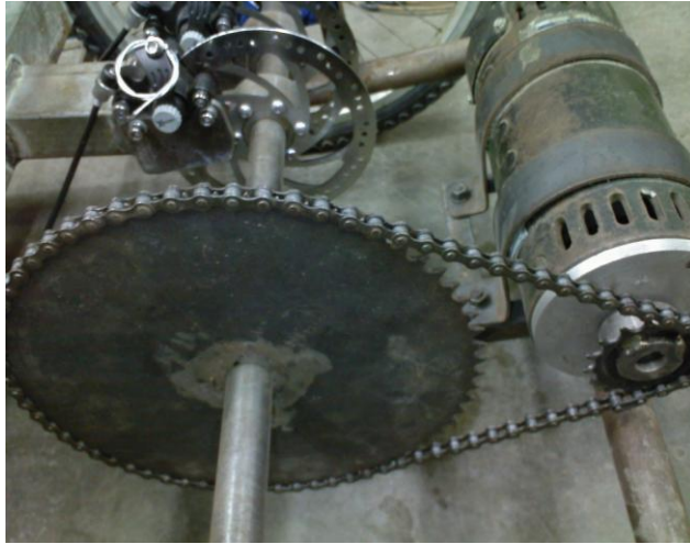
Figura 3.13. Motor conectado directamente al eje de tracción.
