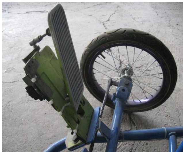
Figura 3.16. Adaptación del potenciómetro al pedal de aceleración.
