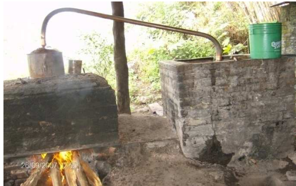
Figura 6. Equipo de destilación artesanal utilizado por el productor
