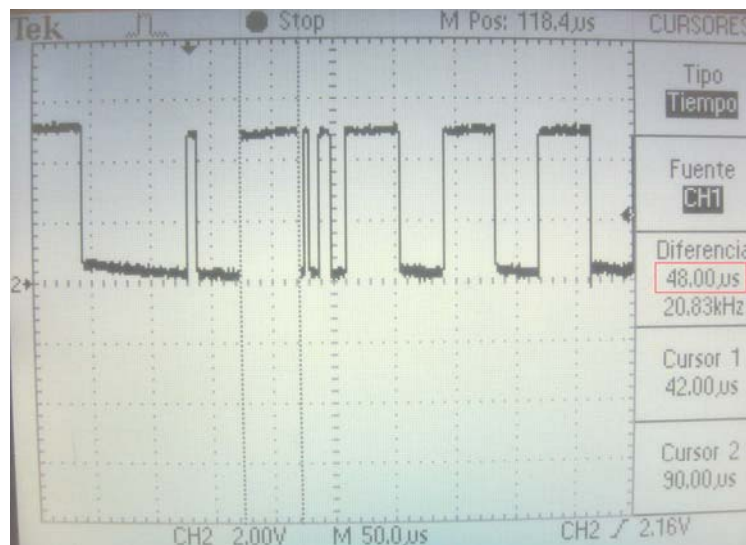
Figura 5.4. Diagrama de tiempos del segmento Mark de la señal DMX512.
