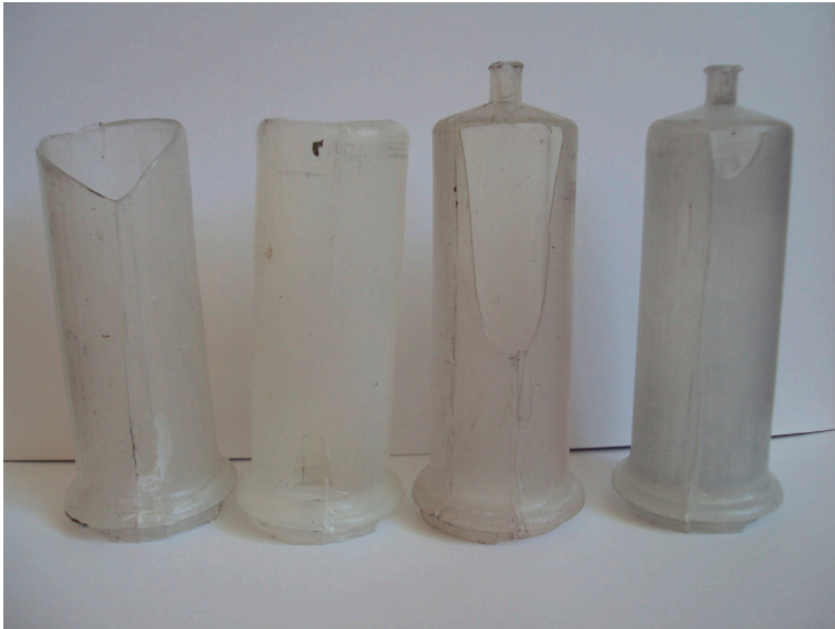
Figura 3.23 Defectos presentados durante el moldeo
