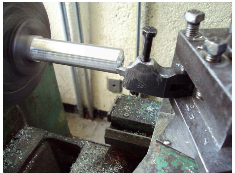
Figura 3.17 Maquinado por torneado del corazón del Molde
