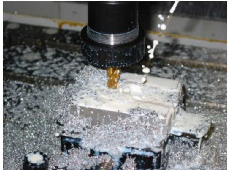
Figura 3.16 Maquinado de moldes por fresado
