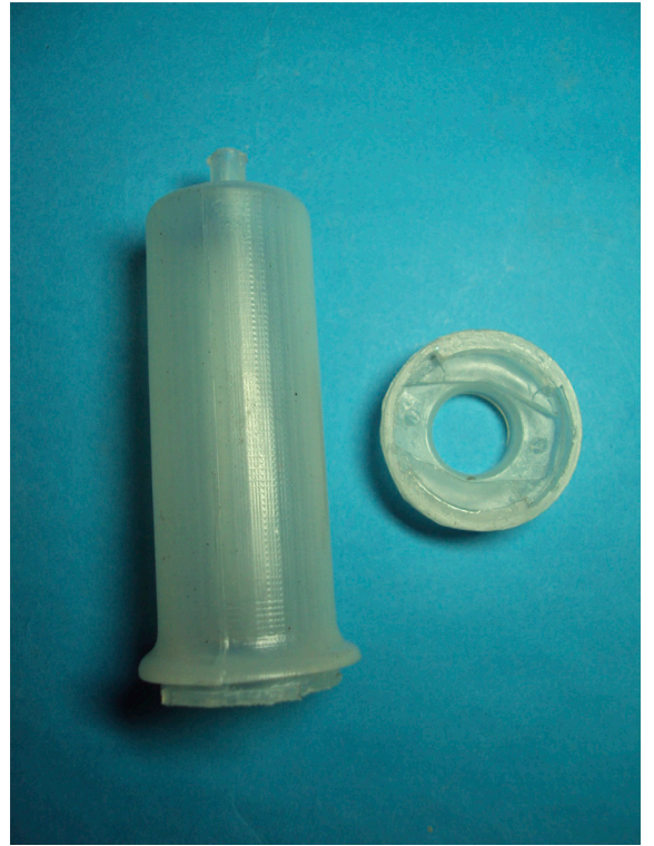
Figura 3.24 Componentes del sistema obtenidos mediante moldeo por inyección
