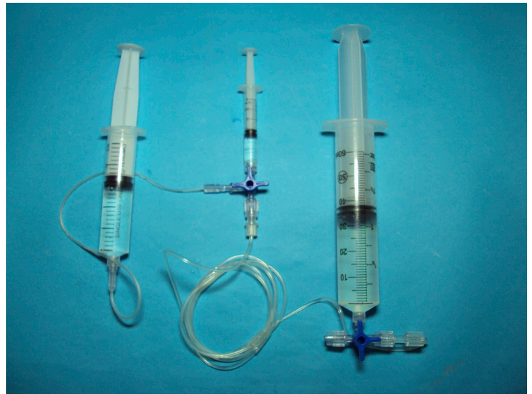
Figura 3.5 Sistema con depósito de fluido incluido
