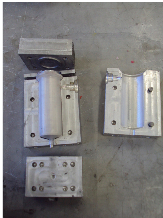
Figura 3.21 Moldeo de la Cámara de Impulsión
