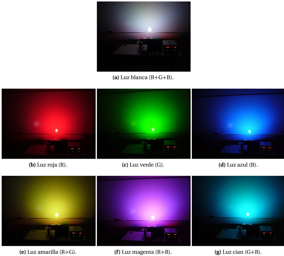
**Figura 4.10.** Diferentes colores de luz generados por el prototipo.
