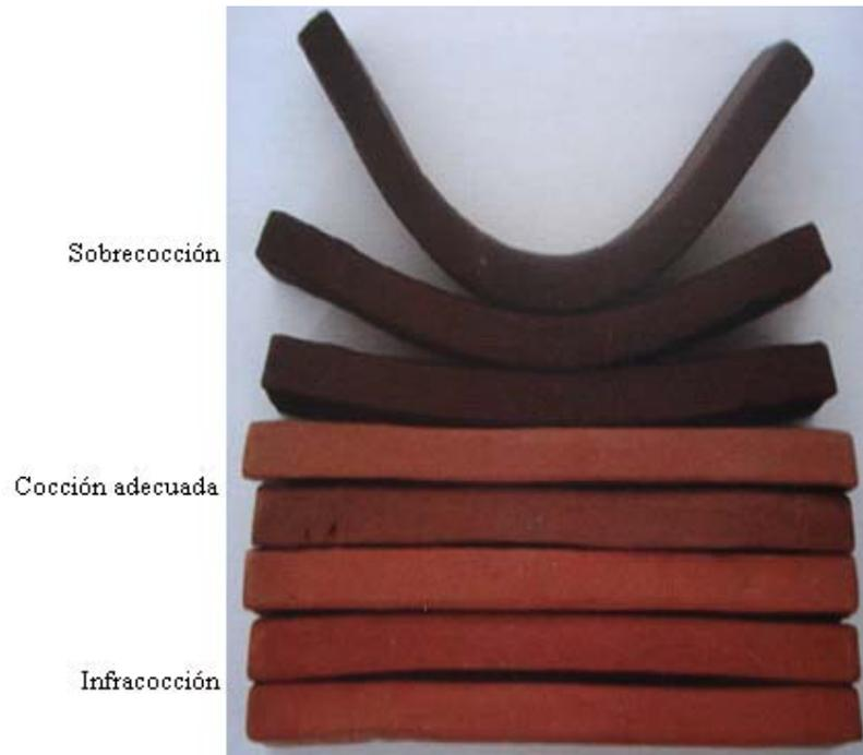
**Figura 2.3** Efectos de la temperatura en la Cerámica
