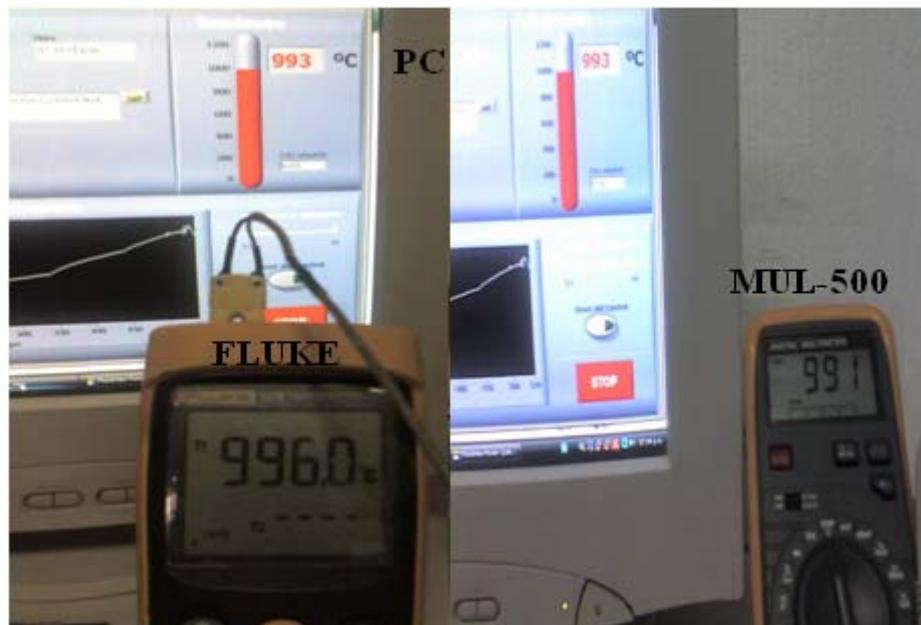
**Figura 4.4** Mediciones realizadas con el termómetro FLUKE 52 II, multímetro MUL-500 y el Sistema (PC)
