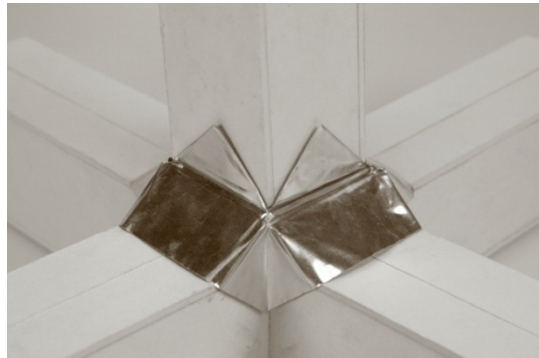
Figura 4.8. La forma No.4 ofrece otra opción para ubicar el ensamble en el apoyo.
