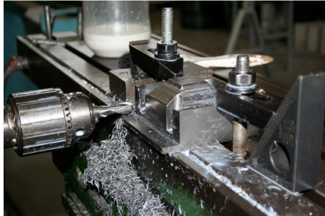
Figura 4.27. Después de realizar el maquinado CNC, se retiró material con una fresadora mecánica.
