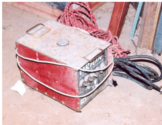
Figura 2.18. Fuente de suministro de energía para soldadura de arco eléctrico con electrodo revestido.
