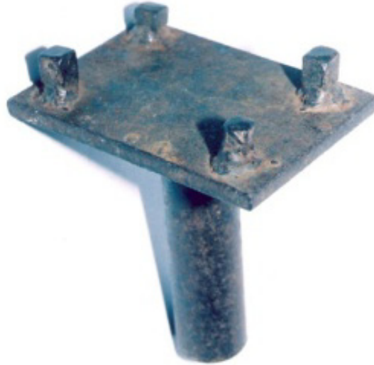
Figura 2.15. Pieza fabricada con tubo, solera, cuadrado y un tramo de varilla.
