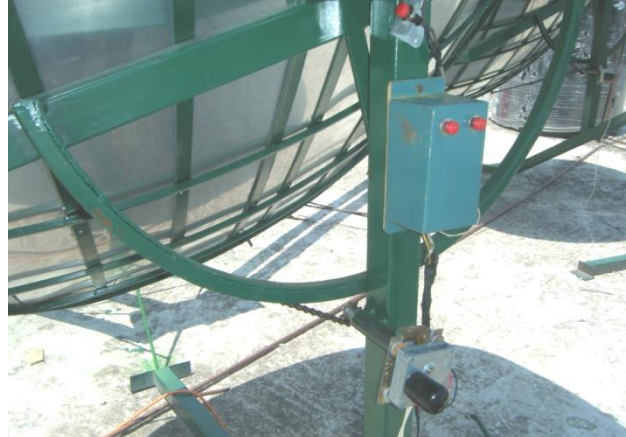
Figura 4.22: Mecanismo automatizado de seguimiento del sol para los concentradores solares. Fuente: Fotografías del tesista
