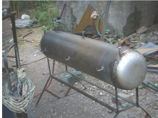
Figura 4.24: Construcción del equipo a base de gas L.P. Fuente: Fotografías del tesista
