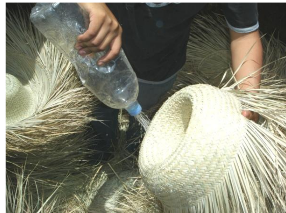
Figura 3.7: Prehumedecido de los sombreros para facilitar su cocción en el proceso
