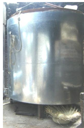
Figura 4.13: Revestimiento con Lamina galvanizada C-22 Fuente: Fotografías del tesista
