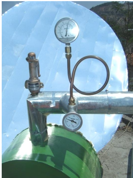
Figura 4.23: Dispositivos de medición del equipo y seguridad del mismo. Fuente: Fotografías del tesista
