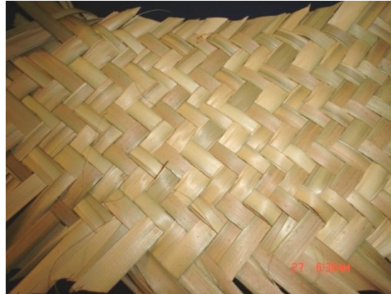
Figura 3.25: Muestra sometida a una concentración 0.23M de vinagre en agua, durante 15 minutos Fuente: Fotografías del tesista
