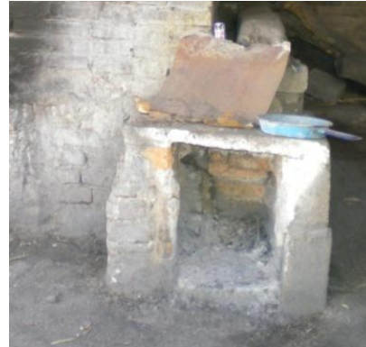
Figura 3.9: Compartimiento del horno para la quema del azufre
