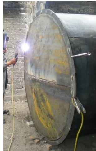
Figura 4.8: Ensamble de la tapa con el cuerpo del horno
