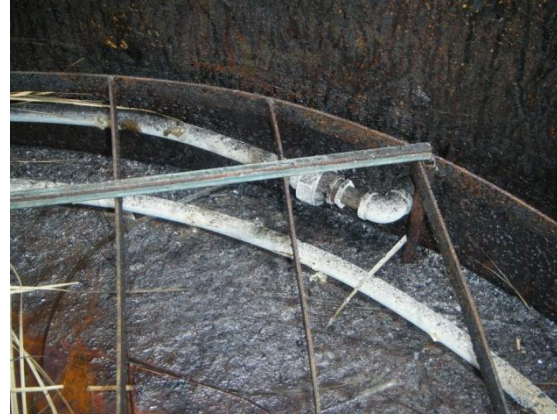
Figura 4.19: Estructura metálica que evitará que el sombrero se moje en el fondo del horno
