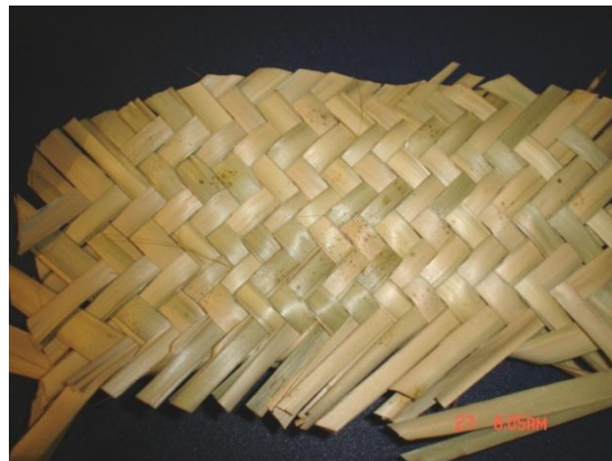
Figura 3.26: Muestra sometida a una concentración 0.28M de vinagre en agua, durante 25 minutos Fuente: Fotografías del tesista
