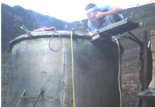
Figura 4.10: Ensamble de la tapa con el cuerpo del horno Fuente: Fotografías del tesista
