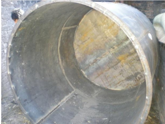
Figura 4.4: Cuerpo del horno armado y soldado
