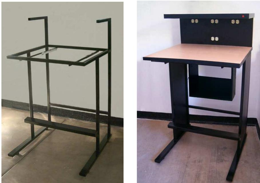
**Figura 6-5.** Mesa de trabajo: estructura y modelo terminado.
