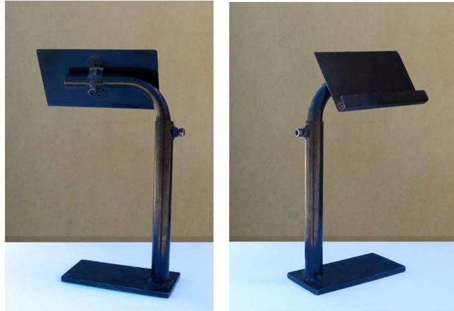
**Figura 6-8.** Soporte de tarjetas de prueba.
