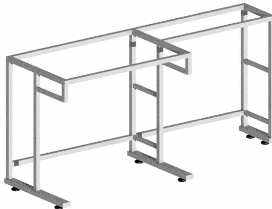
**Figura 5-2.** Estructura metálica para la estación de programación.
