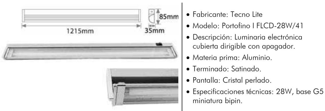
**Figura 5-11.** Luminaria tipo regleta para iluminación suplementaria. (Fuente: Tecno Lite)
