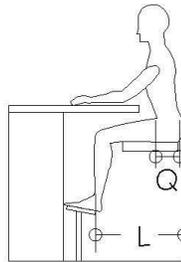
**Figura 4-21.** Distancia glúteo-rodilla (L) y profundidad del cuerpo (Q).
