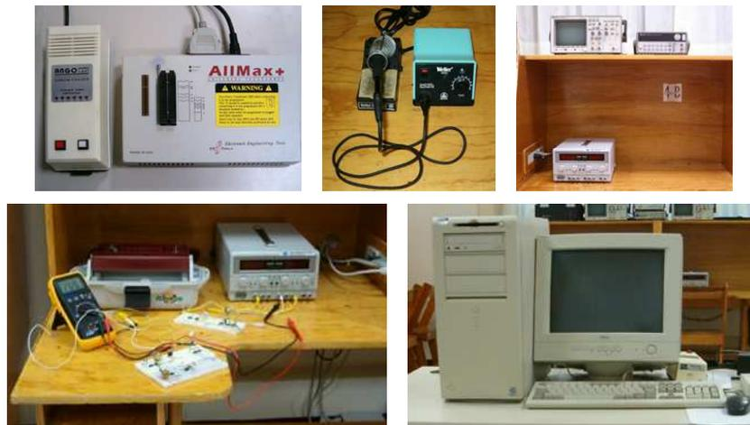
**Figura 2-1.** Equipo, herramientas y componentes empleados en el LEA.
