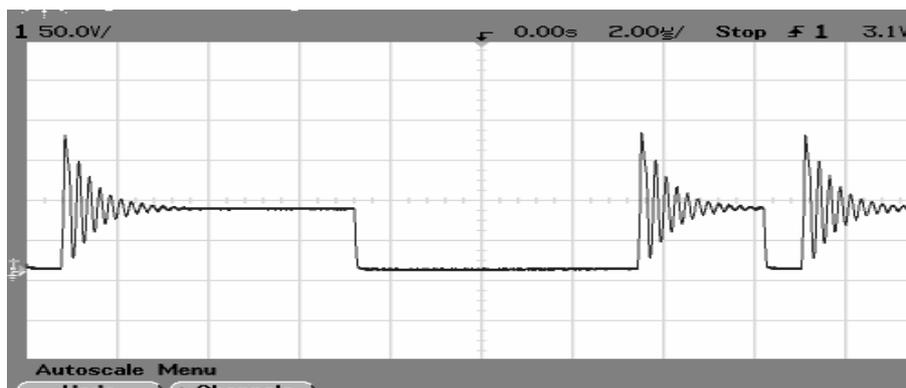
Figura 4.10 Voltaje del Drain TNY279P escala aumentada
