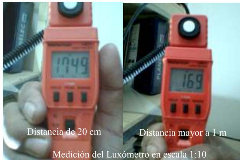
**Figura 4.15** Mediciones con luxómetro del sistema en funcionamiento
