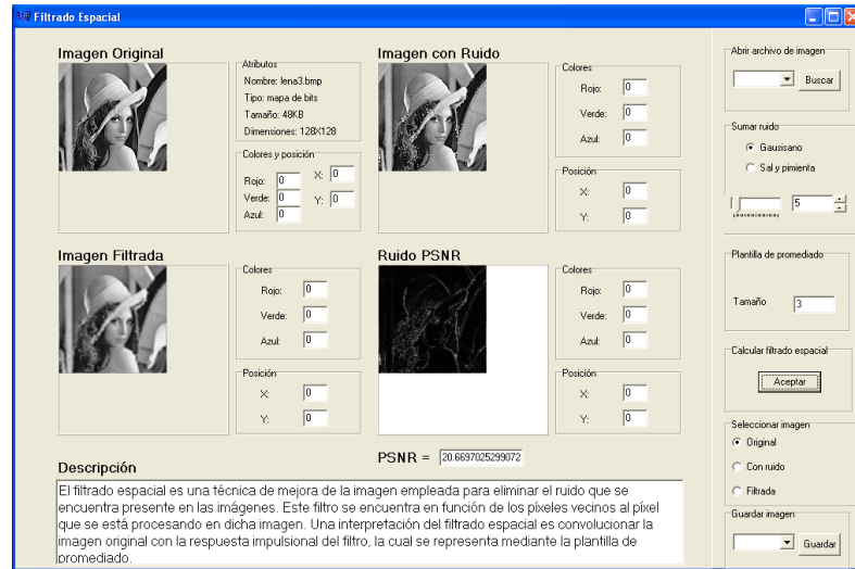
Figura 5.18: Interfaz del algoritmo de filtrado espacial y resultados sobre la imagen Lena.
