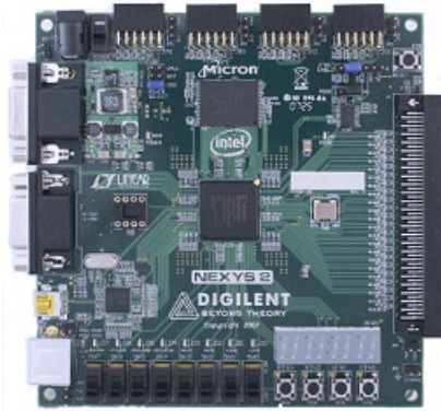
Figura 4.2: Tarjeta de desarrollo de sistemas digitales Nexys-2.
