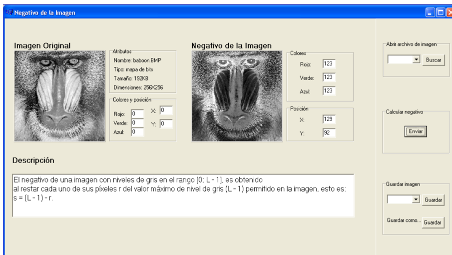
Figura 5.14: Interfaz del algoritmo del negativo de la imagen y resultados del negativo de Baboon.
