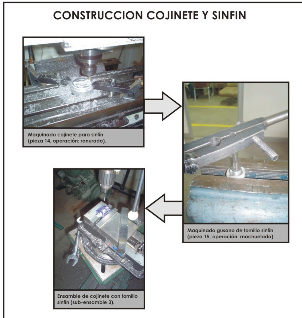
Figura 77. Diagrama de flujo para el maquinado del cojinete y tornillo sinfín.
