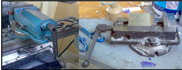
Figura 72. Prensas para sujeción de las piezas de trabajo en el taladro y fresadoras.
