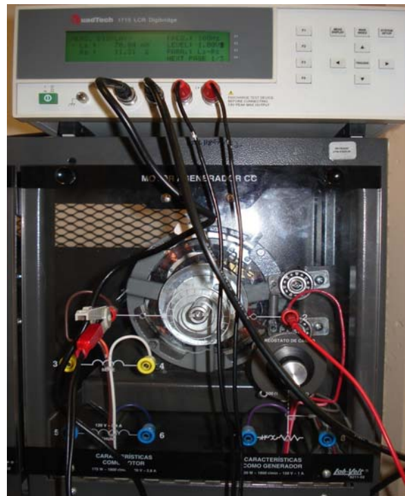
Figura 4.3. Diagrama de conexión para medir la resistencia de armadura.
