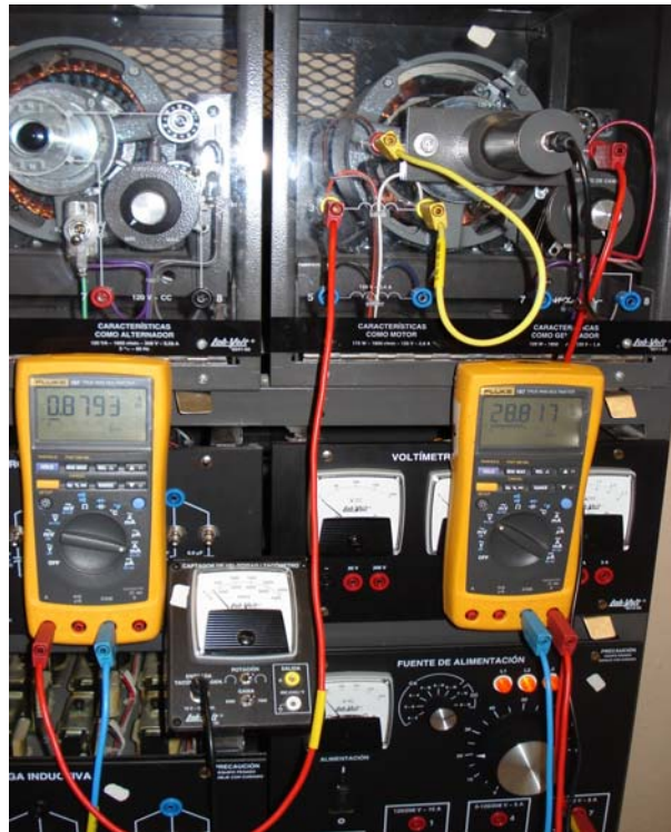
Figura 4.4. Diagrama de conexión de la fuerza contraelectromotriz.
