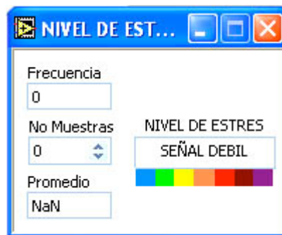
Figura 20. Compilación y ejecución del diagrama a bloques del sistema “Nivel de Estrés” en LabView, dando como resultado la siguiente interfaz o pantalla.
