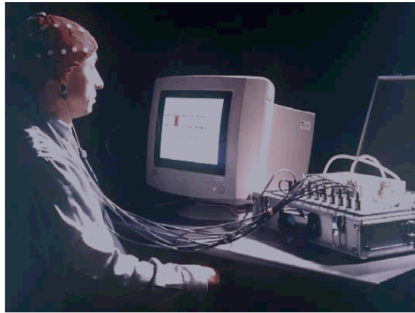
Figura 8. Interfaz cerebral no invasiva para la comunicación. El usuario lleva un gorro con electrodos incorporados (los discos blancos) apoyados sobre el cuero cabelludo y que, con la ayuda de un gel conductor, mide el EEG en diferentes regiones corticales. El usuario selecciona letras del teclado virtual y escribe mensajes [URL10].
