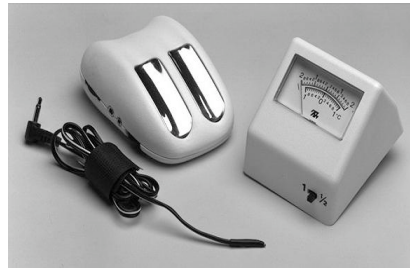
Figura 10. El GSR2 mide la temperatura, actividad de electrodermal (EDA), ritmo cardíaco y tensión muscular. Es uno de los biofeedbacks más utilizados por los psicoanalistas. Con la interpretación de estas señales fisiológicas, se puede dar un diagnóstico y una terapia para el mejoramiento mental de un paciente [URL11].
