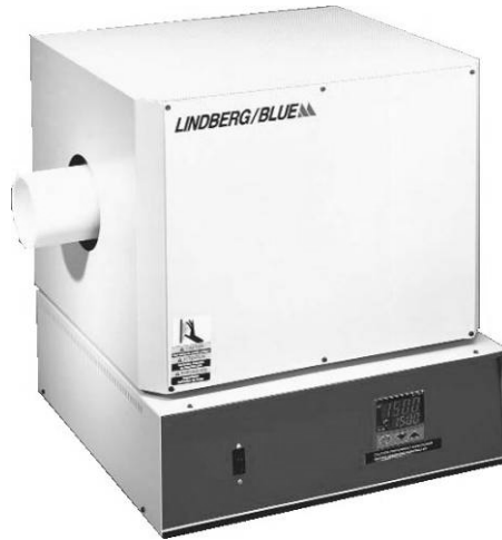
Figura 2-4. Muestra en verde colocada en la cama de SnO 2 y horno para sinterizado.
