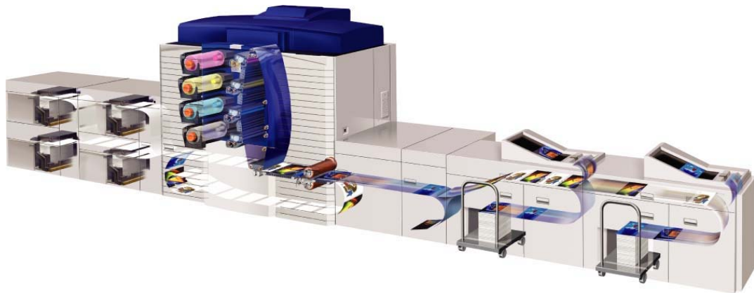
Prensa digital con tecnología Xerográfica iGen3 48
