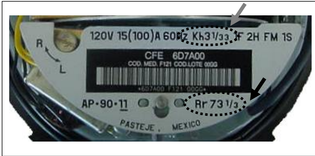
Figura 2.5 Constantes K_h y R_r impresas en placa de datos del medidor
