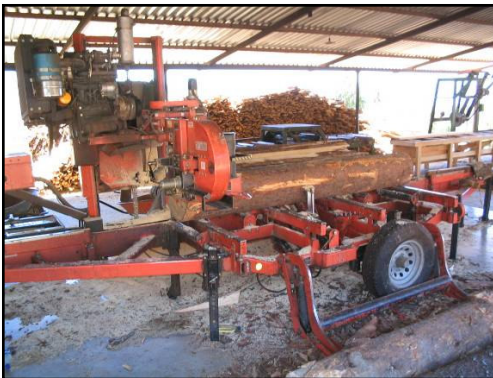
Fotografía 3-3 Aserradero portátil Wood Mizer.
