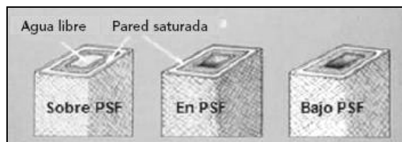
Figura 1-6 Madera sobre el PSF. Presencia de agua libre y agua ligada.
