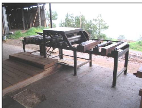
Fotografía 3-5 Desorilladora con 2 sierras circulares.
