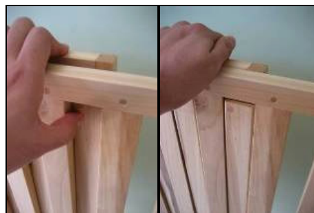
Fotografía 7-11 Ensamble de cabecera.
