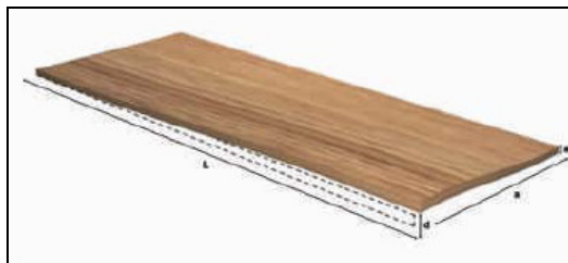
Figura 1-10 Alabeo o deformación de la madera llamado torcedura.
