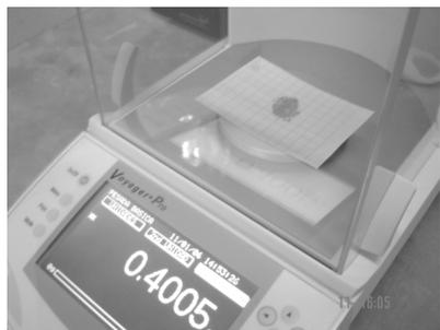
Figura 18. Pesaje de mezcla para compactación.
