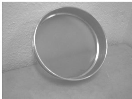
Figura 17. Malla Fiic© de 150 mesh.
