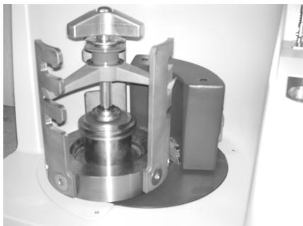
Figura 16. Recipiente de molienda dentro de un molino Retsch® PM100.
