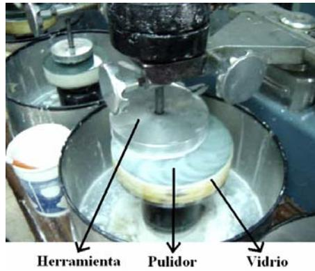
Figura 1.3. -Maquina de pulido clásico: Proceso de pulido.
