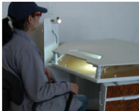
**Solución final:** Adaptar un sistema de iluminación inferior y superior para trabajos minuciosos con detalle y precisión.
