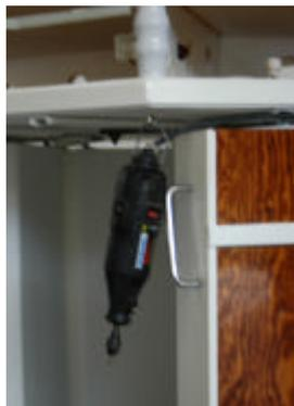
**Solución final:** Se necesita de un aditamento como armellas de 1/8" cercano al usuario para acomodar la herramienta en accesorios de trabajo debajo de la superficie de trabajo para que manos y dedos no ejerzan demasiado esfuerzo muscular al sostener la herramienta.
