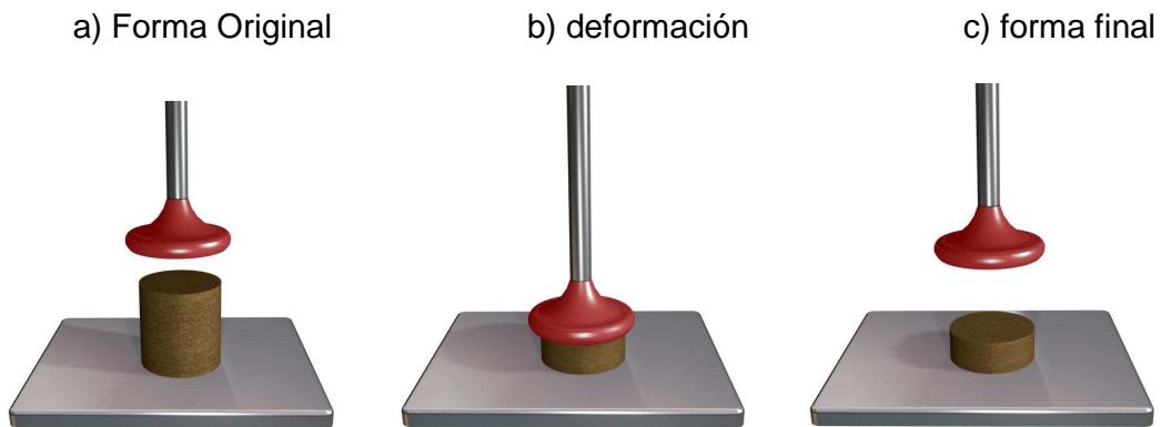
Figura 5. Esquema representativo de la plasticidad
