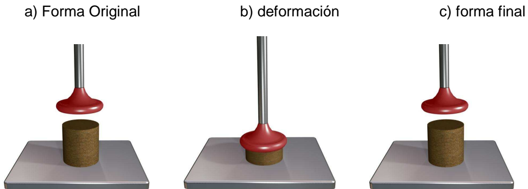
Figura 6. Esquema representativo de la elasticidad
