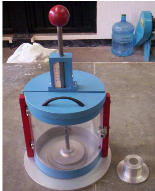
Figura 57. Plasticímetro donde se realizaron las pruebas experimentales
