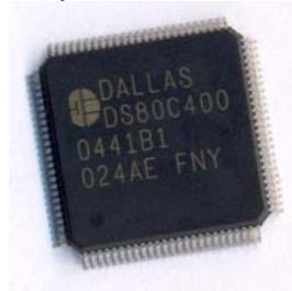
Figura 2.2. Microcontrolador DS80C400 de MAXIM/ Dallas Semiconductor.
