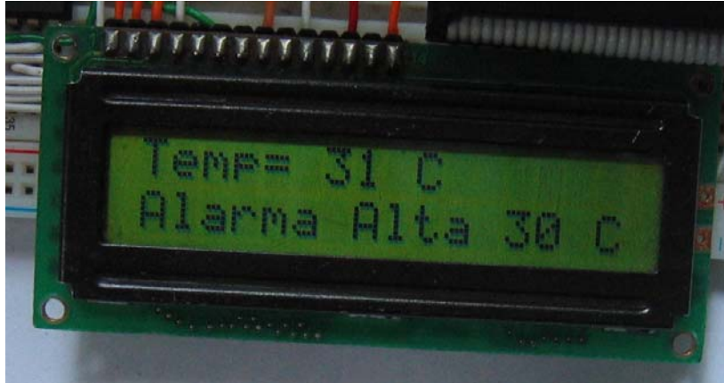
Figura 4.10. Aviso local de activación de alarma.
